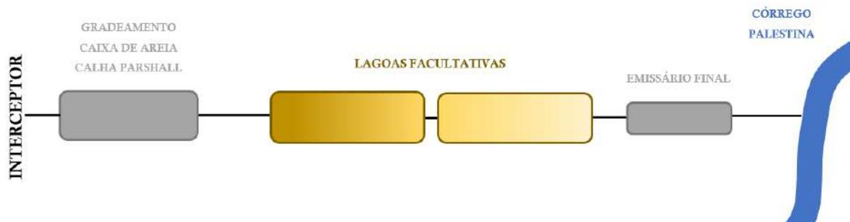
**Figura 160 – Diagrama esquemático da ETE São Francisco.**
