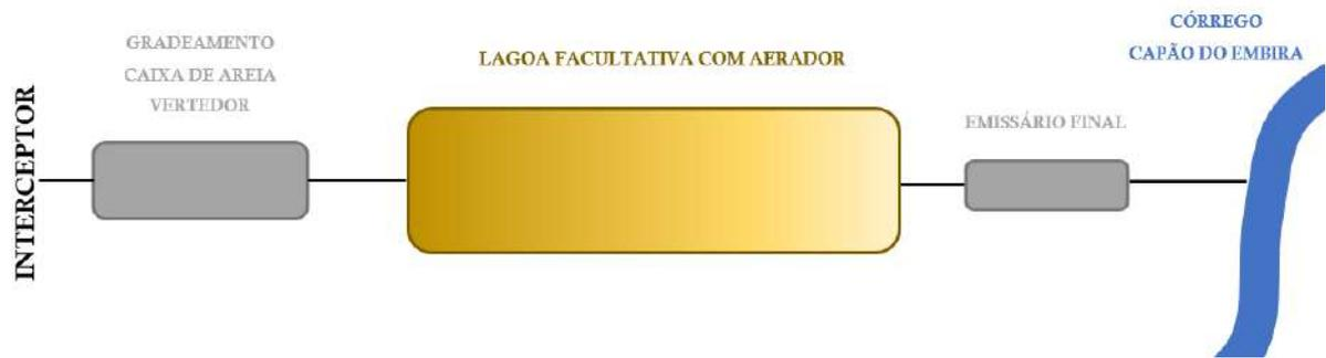
**Figura 152 – Diagrama esquemático da ETE Paulistano I.**
